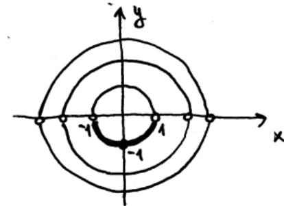
$$x^2 + y^2 = C, \quad C > 0 \quad (C = 2c) \quad \dots \text{implicitní tvar obecného řešení}$$
